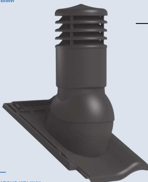
Эргономичный и интуитивный монтаж — облегченный монтаж благодаря присоединительному элементу, всегда расположенному перпендикулярно по отношению к углу наклона ската крыши. Удобный способ стабилизации положения вентиляционного выхода по отношению к скату с помощью специальных шурупов со сверлом. Устанавливаются на крыше с помощью одного инструмента — шуруповерта.
